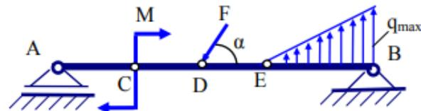
$AC=0,2$  м,  $CD=0,3$  м,  $DE=0,3$  м,  $BE=0,2$  м, угол  $\alpha=60^\circ$
