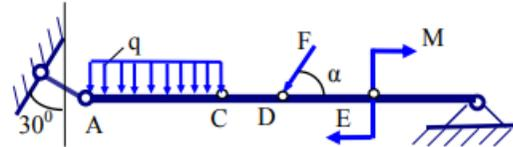
2. На балку АВ действует вертикальная сила  $F=10$  кН, момент  $M=4$ кН/м и распределенная нагрузка интенсивностью  $q=20$  кН/м. Определить в кН реакции опор А и В, если длины  $AC=0,1$  м,  $CD=0,4$  м,  $DE=0,1$  м,  $BE=0,2$  м, угол  $\alpha=30^0$
