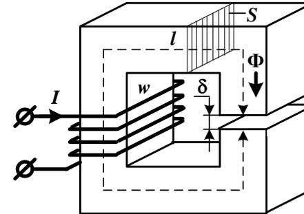
Определить среднюю длину магнитопровода  $l$  (в метрах).
