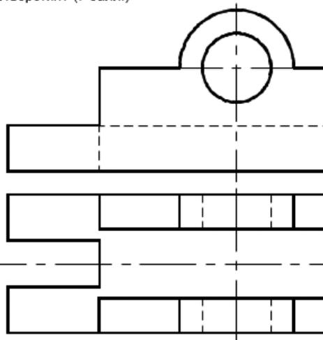
**Задача №4.** Вычертить соединение данных деталей в масштабе 1:1. Дать поперечное сечение по резьбовому соединению. На выполненном резьбовом соединении обозначить произвольную метрическую резьбу с мелким шагом, левую. (3 балл.)
