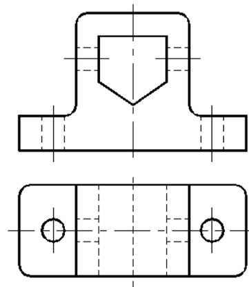
**Задача №4.** Вычертить соединение данных деталей в масштабе 1:1. Дать поперечное сечение по резьбовому соединению. На выполненном резьбовом соединении обозначить упорную резьбу с диаметром 40 мм, шагом 3 мм, числом заходов  $n=3$ . (3 балл.)
