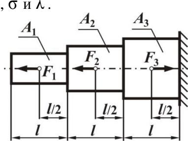
$F_1 = 20 \text{ кН}, F_2 = 25 \text{ кН}, F_3 = 40 \text{ кН}, l = 1 \text{ м}, A_1 = 100 \text{ мм}^2, A_2 = 200 \text{ мм}^2, A_3 = 300 \text{ мм}^2, E = 2 \cdot 10^5 \text{ Мпа}$ <ol style="list-style-type: none"> <li>2. Требуется определить величину и направление момента <math>m_2</math>. Построить эпюры <math>M_x</math> и <math>\tau</math>.</li> </ol> |
