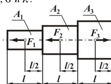
$F_1 = 20 \text{ kH}, F_2 = 25 \text{ kH}, F_3 = 40 \text{ kH}, l = 1 \text{ м}, A_1 = 100 \text{ мм}^2, A_2 = 200 \text{ мм}^2, A_3 = 300 \text{ мм}^2, E = 2 \cdot 10^5 \text{ Мпа}$ <p>2. Требуется определить величину и направление момента <math>m_2</math>. Построить эпюры <math>M_x</math> и <math>\tau</math>.</p> |
