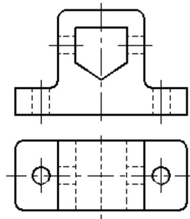
**Задача №4.** Вычертить соединение данных деталей в масштабе 1:1. Дать поперечное сечение по резьбовому соединению. На выполненном резьбовом соединении обозначить специальную метрическую резьбу со стандартным профилем,  $d=80\text{мм}$ ,  $P=3\text{мм}$ . (3 балл.)
