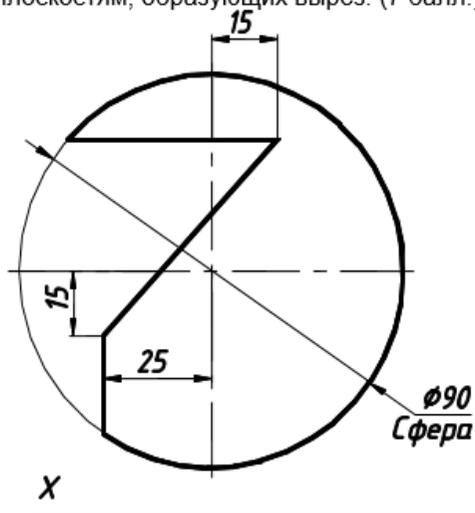
**Задача №2.** Построить три проекции призмы с вырезом. Дать определение плоскостям, образующих вырез. (7 балл.)
