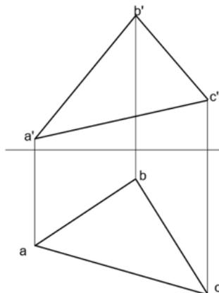
**Задача №1.** В плоскости  $P(AB \cap AC)$  построить восходящую прямую общего положения. Дать определение главным линиям плоскости. (3 балл.).
