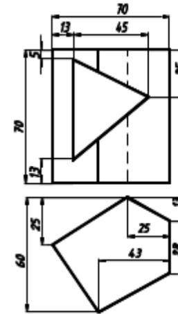
**Задача №3.** Достроить вид слева. Выполнить необходимые разрезы. Нанести размеры. Формообразующие размеры (определение, привести пример). (7 балл.)
