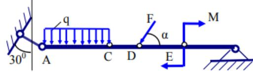
2. На балку АВ действует вертикальная сила  $F=10$  кН, момент  $M=4$ кН/м и распределенная нагрузка интенсивностью  $q=20$  кН/м. Определить в кН реакции опор А и В, если длины  $AC=0,1$  м,  $CD=0,4$  м,  $DE=0,1$  м,  $BE=0,2$  м, угол  $\alpha=30^\circ$
