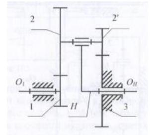
Определить передаточное отношение  $i_{14}$  редуктора Давида с
