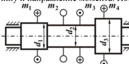
$m_1=100, m_3=280, m_4=60, d_1=30 \text{ мм}, d_2=25 \text{ мм}, d_3=40 \text{ мм}$ <ol style="list-style-type: none"> <li>Требуется построить эпюры <math>Q</math> и <math>M</math> и определить наименьший размер прямоугольной в сечении (<math>H=2,5B</math>) стальной балки при <math>[\sigma]=160 \text{ МПа}</math>.</li> </ol> |
