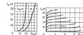
МП42А:  $\Delta I_B = 100\text{мКА}$ ,  $U_{K3max} = 15\text{В}$ ,  $I_{Kmax} = 150\text{мА}$ ,  $P_{Kmax} = 200\text{мВт}$ ,  $C_K = 50\text{пФ}$
