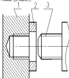
**Задача №4.** Вычертить соединение данных деталей в масштабе 1:1. Дать поперечное сечение по резьбовому соединению. На выполненном резьбовом соединении обозначить упорную резьбу с диаметром 40 мм, шагом 3 мм, числом заходов  $n=3$ . (3 балл.)
