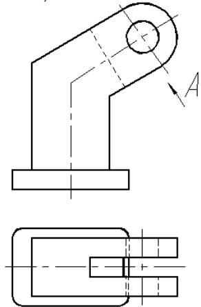
**Задача №3.** Достроить вид слева. Выполнить необходимые разрезы. Нанести размеры. Формообразующие размеры (определение, привести пример). (7 балл.)
