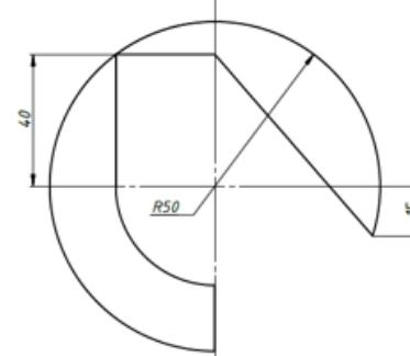
**Задача №3.** Достроить вид слева. Выполнить фронтальный и местный разрезы. Нанести размеры. Как вычерчивается контур сечения, если секущая плоскость проходит через ось цилиндрического, конического или шарового отверстия? (7 балл.)
