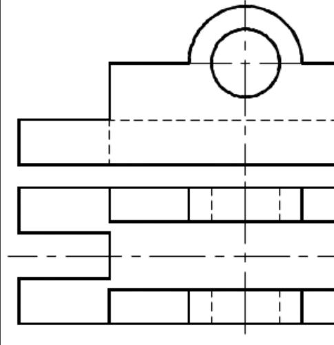
**Задача №4.** Вычертить соединение данных деталей в масштабе 1:1. Дать поперечное сечение по резьбовому соединению. На выполненнем резьбовом соединении обозначить произвольную метрическую резьбу с мелким шагом, левую. (3 балл.)
