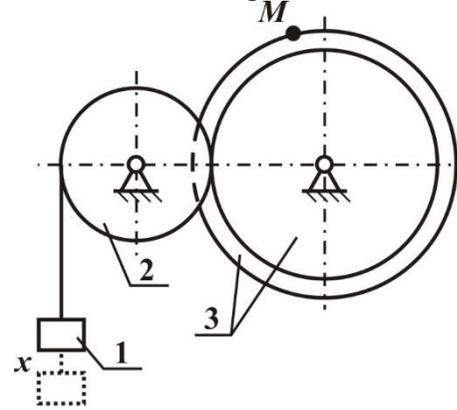
$$\text{Закон движения: } x = 2 + 100t^2, t = 2 \text{ с}, r_2 = 20 \text{ см}, r_3 = 50 \text{ см}, R_3 = 60 \text{ см}$$
