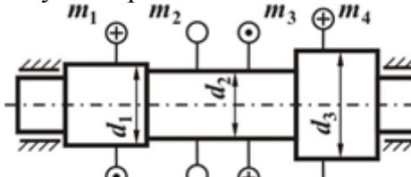
$m_1=100, m_3=280, m_4=60, d_1=30 \text{ мм}, d_2=25 \text{ мм}, d_3=40 \text{ мм}$ <ol style="list-style-type: none"> <li>Требуется построить эпюры <math>Q</math> и <math>M</math> и определить наименьший размер прямоугольной в сечении (<math>H=2,5B</math>) стальной балки при <math>[\sigma]=160 \text{ МПа}</math>.</li> </ol> |
