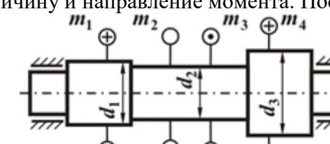
$m_1=100 \text{ , } m_3=280 \text{ , } m_4=60 \text{ , } d_1=30 \text{ мм, } d_2=25 \text{ мм, } d_3=40 \text{ мм}$ <ol style="list-style-type: none"> <li>Требуется построить эпюры <math>Q</math> и <math>M</math> и определить наименьший размер прямоугольной в сечении (<math>H=2,5B</math>) стальной балки при <math>[\sigma]=160</math> МПа.</li> </ol> |
