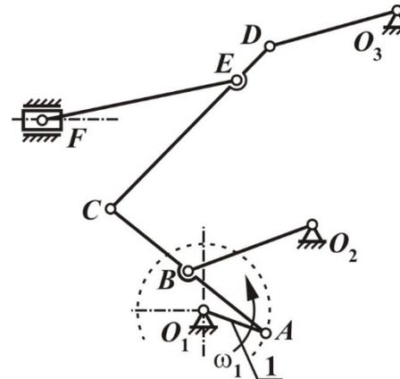
Кривошип  $O_1A$  вращается с постоянной угловой скоростью  $\omega_1$ .
