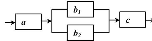
Найти надежность системы – вероятность того, что система будет исправна в течении некоторого времени, если известны надежности блоков  $P(a) = 0.95$ ,  $P(b_k) = 0.9$ ,  $P(c) = 0.99$ .
