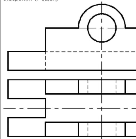
**Задача №4.** Вычертить соединение данных деталей в масштабе 1:1. Дать поперечное сечение по резьбовому соединению. На выполненном резьбовом соединении обозначить произвольную метрическую резьбу с мелким шагом, левую. (3 балл.)
