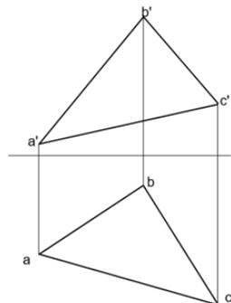
**Задача №1.** В плоскости  $P(AB \perp AC)$  построить восходящую прямую общего положения. Дать определение главным линиям плоскости. (3 балл.)
