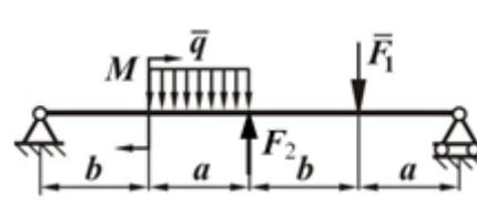
Дано:  $q=20$  кН/м,  $F_1=12$  кН,  $F_2= 5$  кН,  $M=10$  кНм,  $a=3$  м,  $b=2$  м
