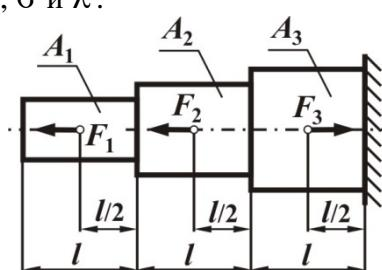
$F_1 = 20 \text{ kH}, F_2 = 25 \text{ kH}, F_3 = 40 \text{ kH}, l = 1 \text{ м}, A_1 = 100 \text{ мм}^2, A_2 = 200 \text{ мм}^2, A_3 = 300 \text{ мм}^2, E = 2 \cdot 10^5 \text{ Мпа}$ <ol style="list-style-type: none"> <li>2. Требуется определить величину и направление момента <math>m_2</math>. Построить эпюры <math>M_x</math> и <math>\tau</math>.</li> </ol> |
