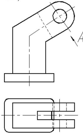
**Задача №3.** Достроить вид слева. Выполнить необходимые разрезы. Нанести размеры. Формообразующие размеры (определение, привести пример). (7 балл.)
