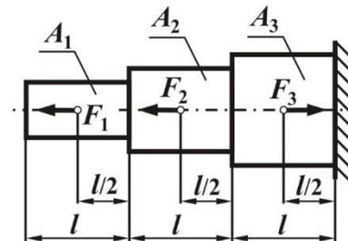
$$F_1 = 20 \text{ кН}, F_2 = 25 \text{ кН}, F_3 = 40 \text{ кН}, l = 1 \text{ м}, A_1 = 100 \text{ мм}^2, A_2 = 200 \text{ мм}^2, A_3 = 300 \text{ мм}^2, E = 2 \cdot 10^5 \text{ МПа}$$
