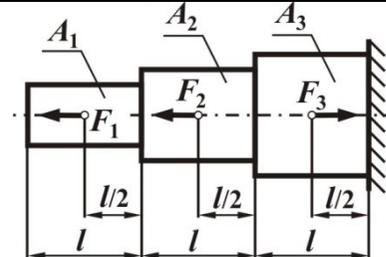
$$F_1 = 20 \text{ кН}, F_2 = 25 \text{ кН}, F_3 = 40 \text{ кН}, l = 1 \text{ м}, A_1 = 100 \text{ мм}^2, A_2 = 200 \text{ мм}^2, A_3 = 300 \text{ мм}^2, E = 2 \cdot 10^5 \text{ МПа}$$
