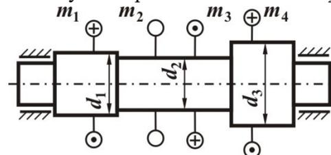
$$m_1 = 100 \text{ Н} \cdot \text{м}, m_3 = 280 \text{ Н} \cdot \text{м}, m_4 = 60 \text{ Н} \cdot \text{м}, d_1 = 30 \text{ мм}, d_2 = 25 \text{ мм}, d_3 = 40 \text{ мм}$$
