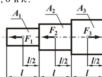
$F_1 = 20 \text{ kH}, F_2 = 25 \text{ kH}, F_3 = 40 \text{ kH}, l = 1 \text{ м}, A_1 = 100 \text{ мм}^2, A_2 = 200 \text{ мм}^2, A_3 = 300 \text{ мм}^2, E = 2 \cdot 10^5 \text{ Мпа}$ <ol style="list-style-type: none"> <li>2. Требуется определить величину и направление момента <math>m_2</math>. Построить эпюры <math>M_x</math> и <math>\tau</math>.</li> </ol> |
