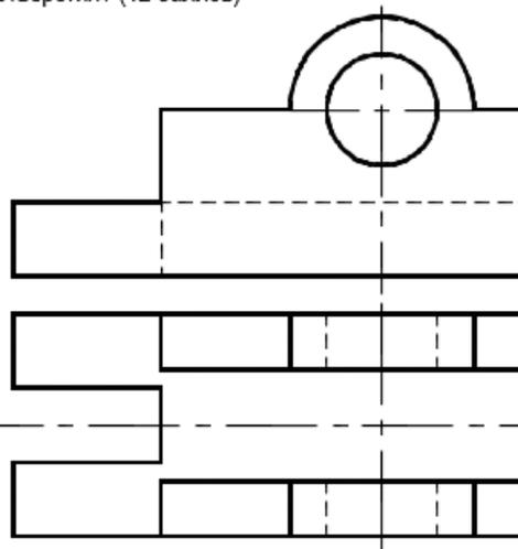
**Задача №4.** Вычертить соединение данных деталей в масштабе 1:1. Дать поперечное сечение по резьбовому соединению. На выполненном резьбовом соединении обозначить произвольную метрическую резьбу с мелким шагом, левую. (5 баллов)
