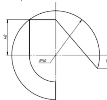
**Задача №3.** Достроить вид слева. Выполнить фронтальный и местный разрезы. Нанести размеры. Как вычерчивается контур сечения, если секущая плоскость проходит через ось цилиндрического, конического или шарового отверстия? (12 баллов)
