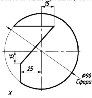
**Задача №2.** Построить три проекции призмы с вырезом. Дать определение плоскостям, образующих вырез. (7 балл.)
