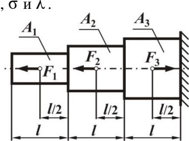
$F_1 = 20 \text{ кН}, F_2 = 25 \text{ кН}, F_3 = 40 \text{ кН}, l = 1 \text{ м}, A_1 = 100 \text{ мм}^2, A_2 = 200 \text{ мм}^2, A_3 = 300 \text{ мм}^2, E = 2 \cdot 10^5 \text{ Мпа}$ 2. Требуется определить величину и направление момента $m_2$ . Построить эпюры $M_x$ и $\tau$ . |
