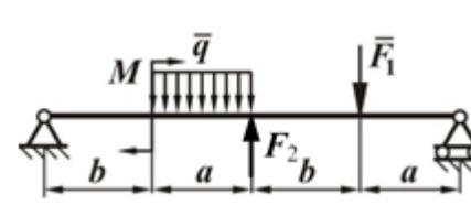
Дано:  $q=20 \text{ кН/м}$ ,  $F_1=12 \text{ кН}$ ,  $F_2=5 \text{ кН}$ ,  $M=10 \text{ кНм}$ ,  $a=3 \text{ м}$ ,  $b=2 \text{ м}$
