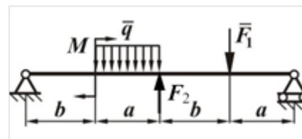
Дано:  $q=20$  кН/м,  $F_1=12$  кН,  $F_2= 5$  кН,  $M=10$  кНм,  $a=3$  м,  $b=2$  м
