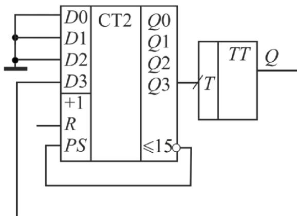
Определить значение, которое необходимо подать на вход, чтобы получить коэффициент счета схемы = 17.
